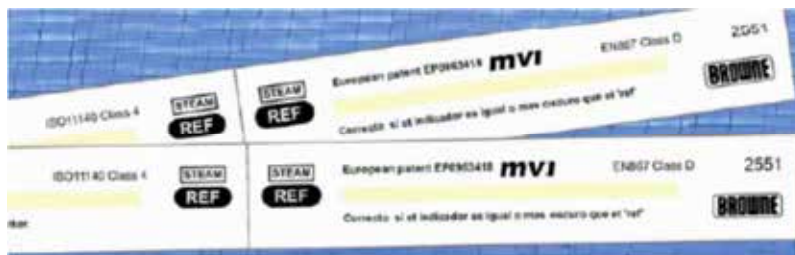
شکل ۷. شمایی از نشان‌گرهای چندپارامتری استریلیزاسیون
