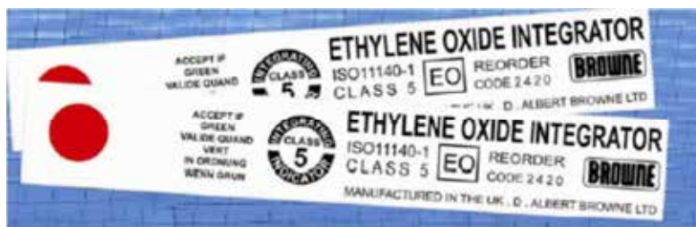
شکل ۸. شمایی از نشان‌گرهای جامع استریلیزاسیون
